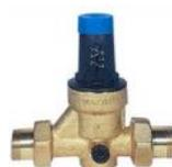
**1932** Réducteur de pression Ø 1¼M, construction en bronze, PN 25, réglable sans outil, filtre à tamis incorporé, avec prise pour manomètre, Watts DRV32N
